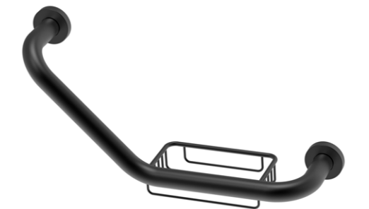
061900-N Asa bañera curva con jabonera. Acabado: negro mate. Material: latón. Grab rail with shower basket. Finish: matte black. Material: brass. 165 x 510 x 120 mm.
