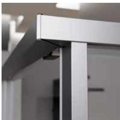
◀ Cierre con perfil a 45°. Altura del perfil guía de 20 mm. Fijación con perfiles de aluminio del mismo grosor que la puerta.
