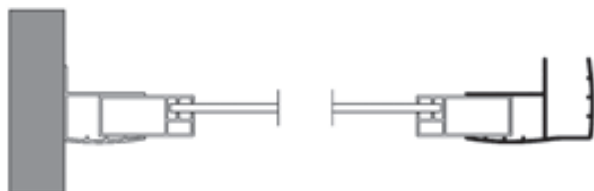
Correct installation of the corner profile Instalación correcta del perfil angular
