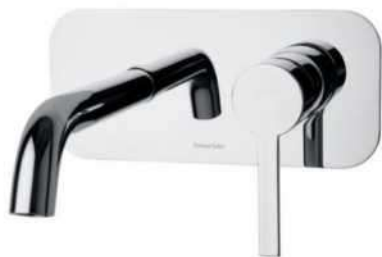
MONOMANDO MURAL CON PLACA Cartucho cerámico Ø35 mm. caño de 19cm, cromado Diamond Finish, sistema S2 de ahorro de agua, limitador de temperatura y sistema anticorrosión patentado. COD. 127500
