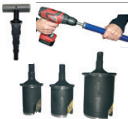
Calibra el diámetro interior del tubo y rebaba la arista para que al montar el accesorio no dañe la junta.
