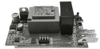
Controlador de presión electrónico Electronic pressure controller Contrôleur de pression électronique
