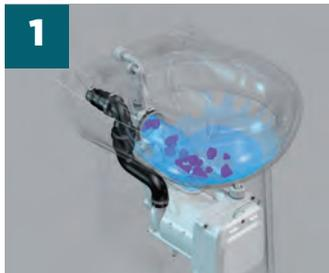
**1** Apretando el botón, se envía una señal a la tarjeta electrónica ubicada en la caja del motor. Es la tarjeta que controla la apertura de la electroválvula. El agua entra en la cerámica y aclara las paredes del inodoro.
