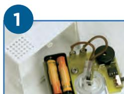
**1** Insertar 2 pilas de 1,5 V (no incluidas) en la caja.
