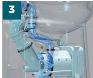
**3** Los efluentes están triturados por el disco de cuchillas y evacuados por el tubo de evacuación. Una válvula antirretorno en el codo de evacuación evita que las aguas negras vuelvan al interior del inodoro.
