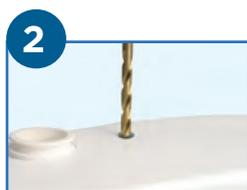
**2** Realizar un agujero de 10 mm de diámetro en la tapa del aparato (hay una marca especial para la instalación del Sanialarm).
