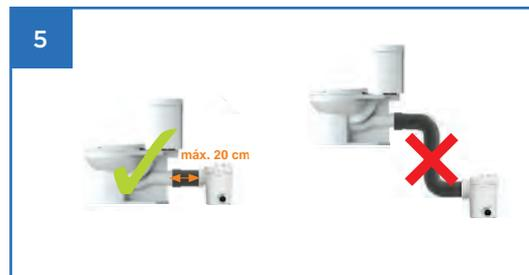
• El aparato debe estar colocado detrás del inodoro a 20 cm como máximo. No se puede instalar a un nivel inferior.
